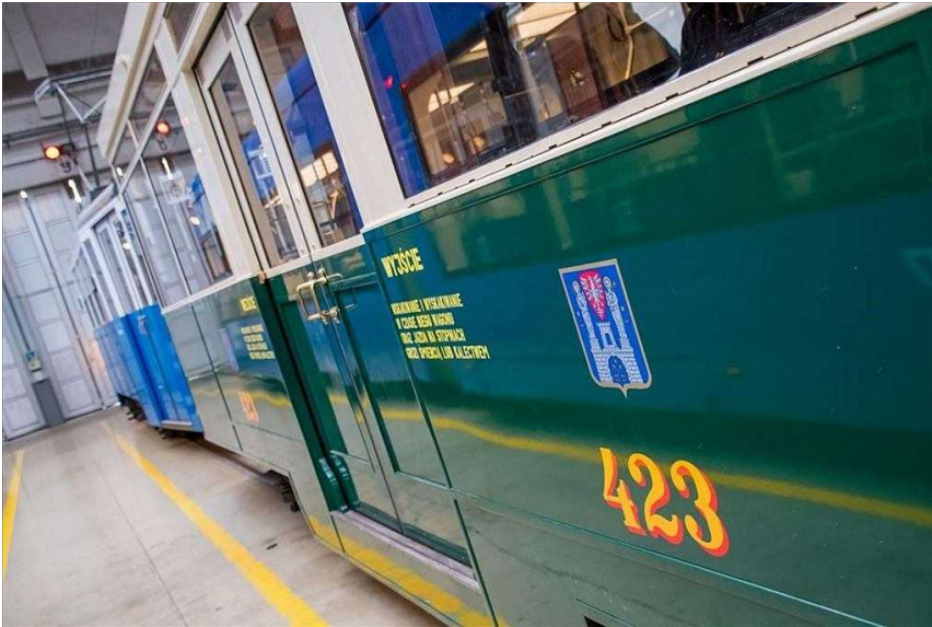
Wyremontowany wagon doczepny S2D MPK Kraków
