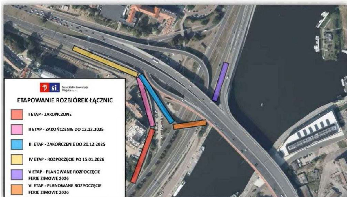
Rozbiórka łącznic Trasy Zamkowej. Etapy prac fot. Szczecińskie Inwestycje Miejskie
