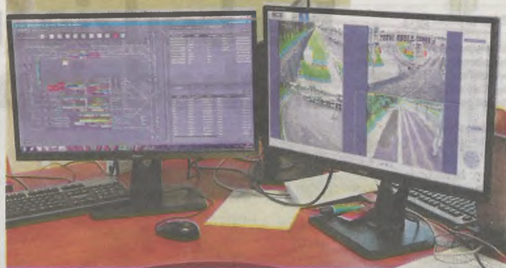
► System zarządzania zajezdnią - to tu widoczne są wszystkie tory i tramwaje, które się na nich znajdują. Z tego komputera mogą zostać wydane dyspozycje, jak może poruszać się dany skład po zajezdni
