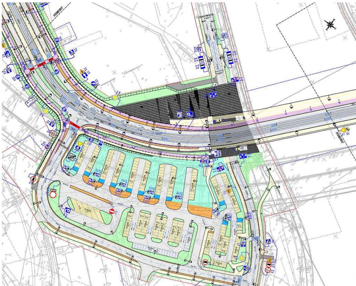
Układ drogowy na Łasztowni, przy zjeździe z mostu (widoczny po prawej stronie) fot. dokumentacja projektowa Egis Polska Inżynieria Sp. z o.o
